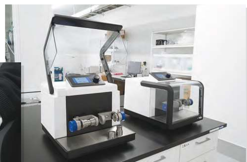
MM400ボールミル (高い粉砕力を持つミキサーミル装置)
